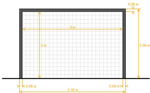
Ворота должны иметь стабилизирующую систему, которая предотвращает их опрокидывание. Они не должны быть закреплены к поверхности площадки, но должны иметь достаточный вес сзади, чтобы позволить стойкам ворот умеренно двигаться, не подвергая опасности участников.
